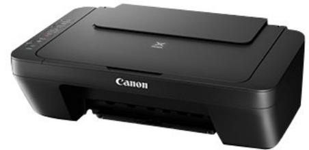
Produktbeschreibung: Canon PIXMA MG3050 - Multifunktionsdrucker - Farbe - Tintenstrahl - 216 x 297 mm (Original) - A4/Legal (Medien) - bis zu 8 ipm (Drucken) - 60 Blatt - USB 2.0, Wi-Fi(n)
