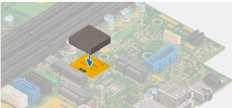
2. Lösen Sie die Schutzfolie von der Wärmefalle.
