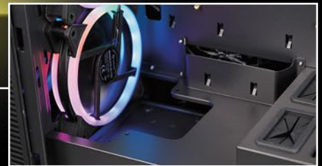
Entfernbarer Abdeckung für die Installation eines Radiators
