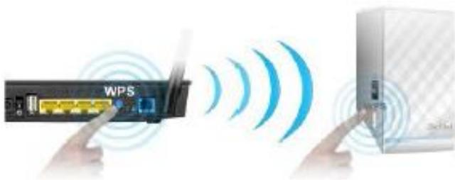
Auch die Einbindung des RP-N53 ins Heimnetzwerk ist deutlich einfacher. Es reicht den WPS Knopf am ASUS Router und am Repeater zu drücken, schon gleichen die Geräte ein sicheres WPA2 Passwort ab. Alternativ lassen sich alle Einstellungen über die innovativen ASUS Benutzeroberfläche (ASUS-WRT) ganz intuitiv steuern.
